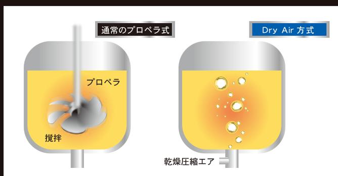
モーターオイルのブレンド工程では、ドライエア方式を導入。ブレンドタンクの底から乾燥エアを送り込んでかき混ぜる方法で、不純物を極端に嫌う冷凍機油のブレンド方法を採用しています。一般的なプロペラ攪拌法で懸念される機械部の油分などや水分が混入する可能性を限りなくゼロに近づけています。
